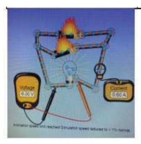
Zapojení paralelní s rozdílným napětím ve zdrojích U1 je 9V a U2 je 3V při tomto zapojení dochází ke zkratu.
